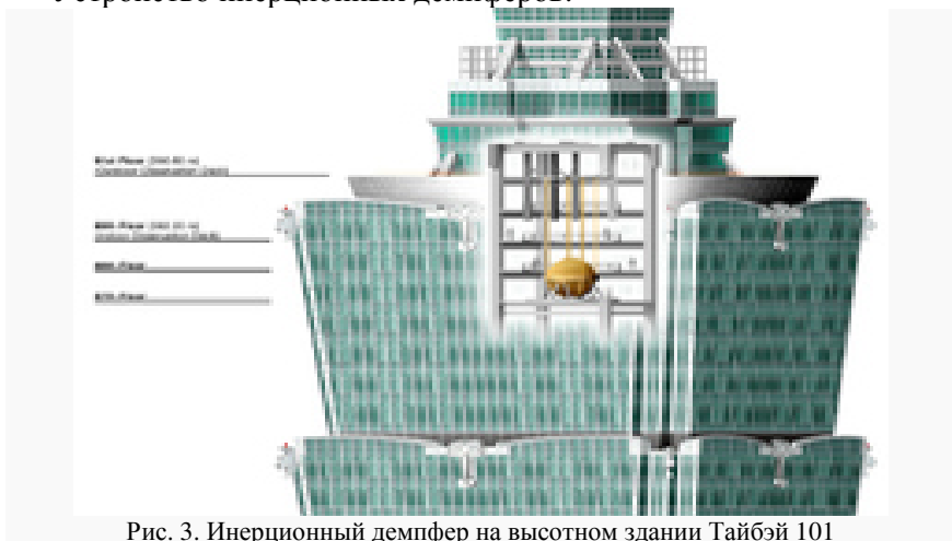
Рис. 3. Инерционный демпфер на высотном здании Тайбэй 101
