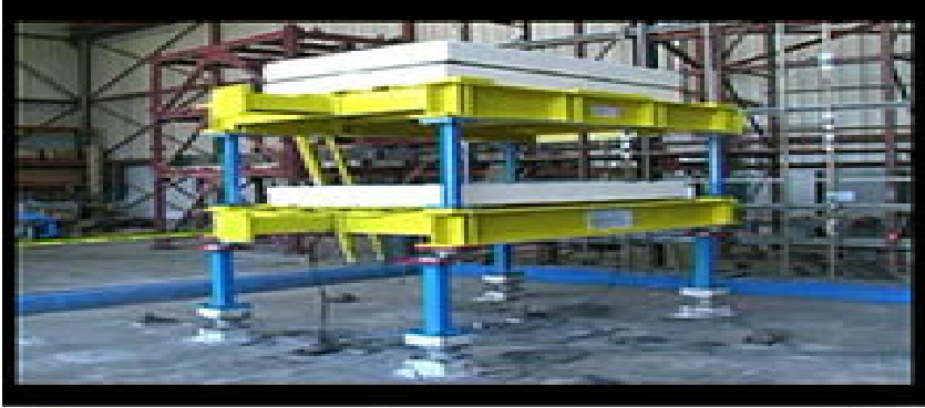
Рис. 7. Фрикционно-маятниковая опора: вибро-испытание
