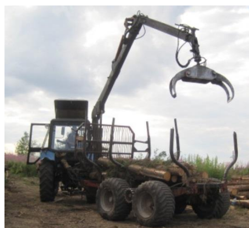
Рис. 2. Вид на привод колес прицепа-форвардера
