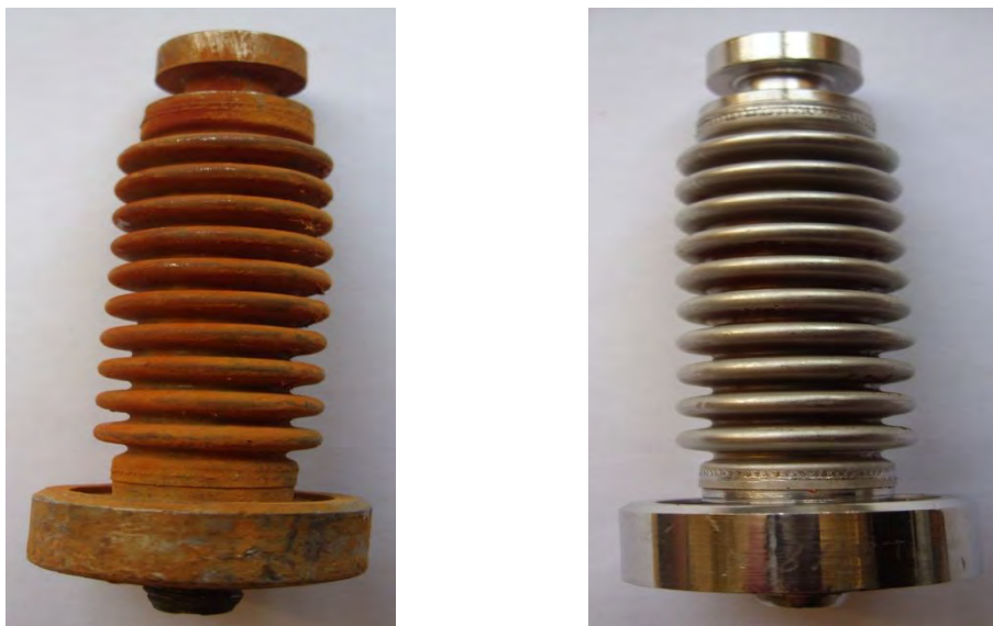
Рисунок 1. – Сифон до и после очистки
