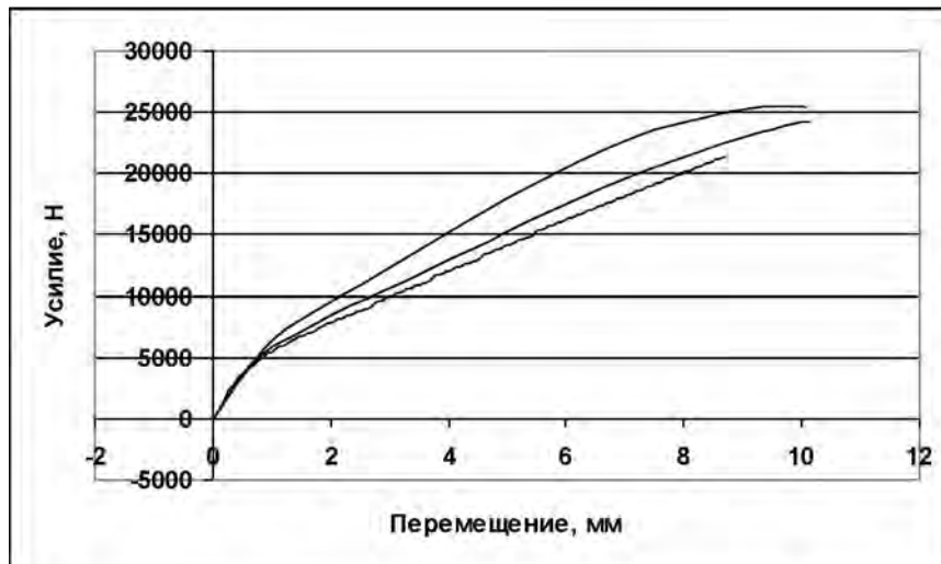
Рисунок 1. – Зависимость «Усилие (Н) – перемещение (мм)» для материала Флувис 20. Скорости 5(нижняя), 40(средняя), 100(верхняя) мм/мин.
