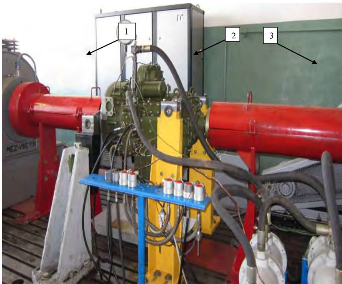
1 – балансирный динамометр 1DS 1146 кV № 855675 (привод); 2 – испытуемый узел (ГМП); 3 – балансирный динамометр 1DS 1146 кV № 850133 (тормоз)
