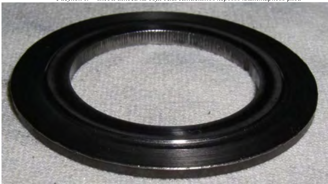
Рисунок 7. – Износ одной из четырех шайб сателлитов третьего планетарного ряда
