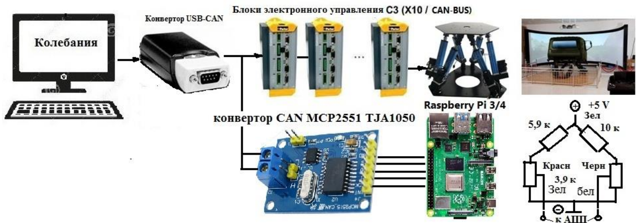
Рисунок Ж.1 – Электрическая схема управления стендом
