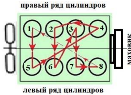
Рисунок 3.48. – Порядок работы цилиндров V8-образного двигателя
