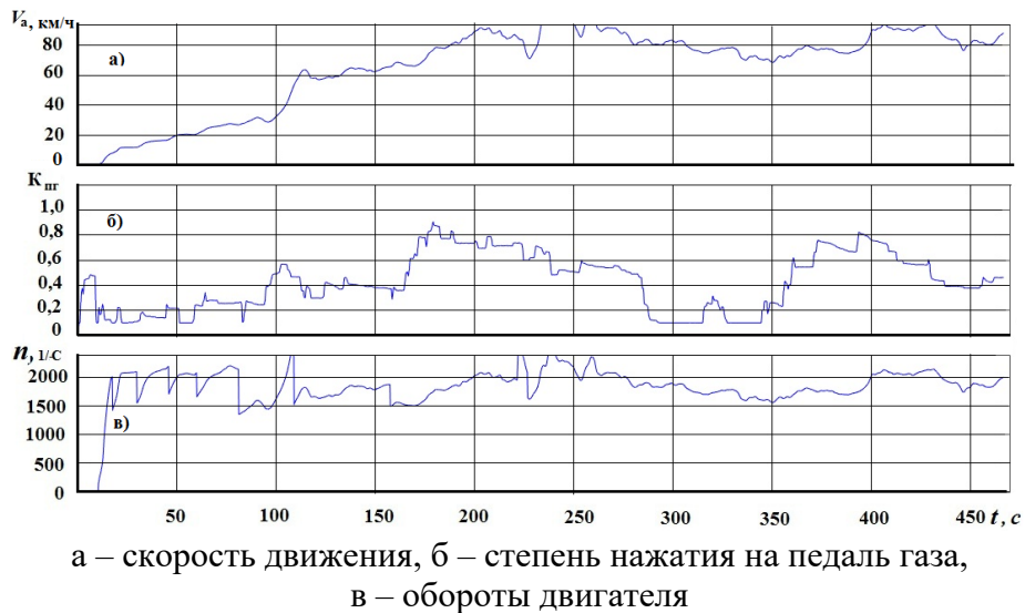
Рисунок 7.4 – Результаты имитационного моделирования движения автомобиля при ручном переключении передач КПП
