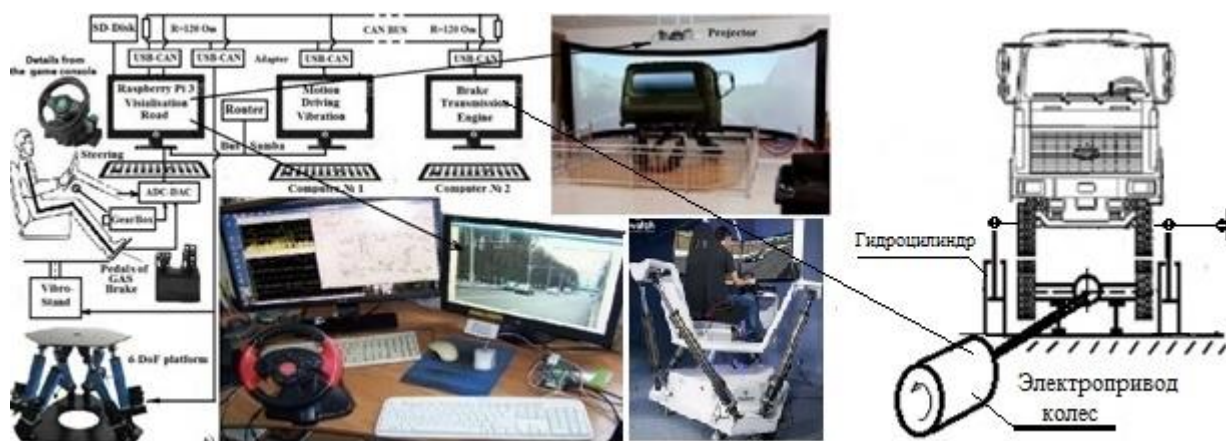
Рисунок В.7. – Предлагаемая схема имитационного моделирования автомобиля со стендом и смешанной реальностью
