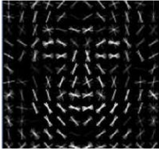
Рисунок 1 – Пример гистограммы направленных градиентов, полученной на большом количестве фотографий (а), выбор базовых ориентиров (б), пример кодировки лица (в).
