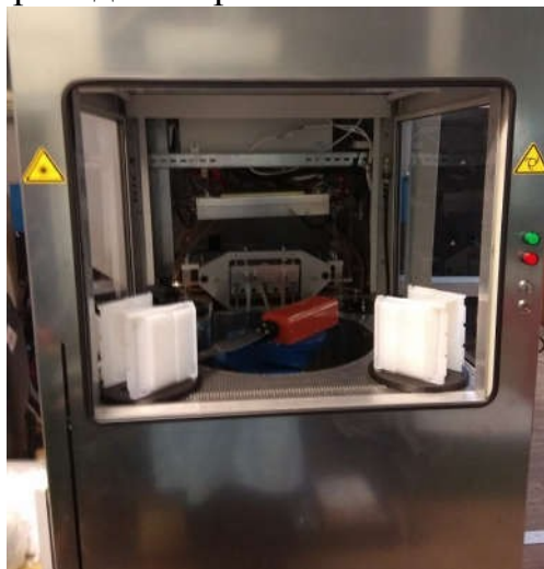
Рис.1 – Устройство автоматизации отжига кремниевых пластин
