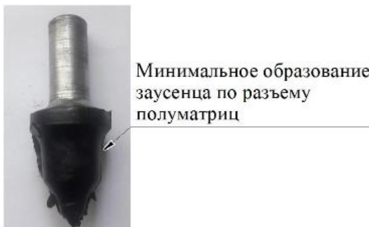
Рисунок 3 – Внешний вид биметаллического резца выдавленного с начальной скоростью деформирования v_0 = 80 м/с ( T_0 = 1240 °С; \lambda_1 = 3,34 )
