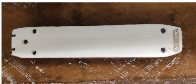
Рисунок 4 – Модель несамходного судна в гидродинамическом лотке (вид сверху)
