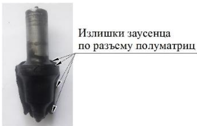
Рисунок 1 – Внешний вид биметаллического резца выдавленного с начальной скоростью деформирования v_0 = 100 м/с ( T_0 = 1240 °С; \lambda_1 = 3,34 )
