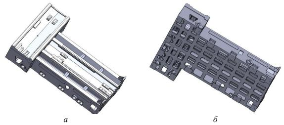
Рис. 4. Станина станка (Basement SGH630-HP): a – вид сверху;  $\delta$  – вид снизу
