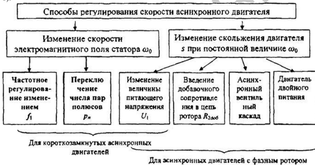
Рисунок 1. Классификация способов регулирования скорости асинхронных двигателей
