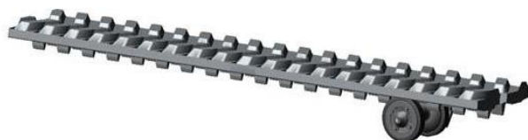
Рисунок 2 – Общий вид модели для определения затрат мощности на вращение ПК с учетом взаимодействия с РАГ при различных скоростях движения трактора в среде MSC Adams
