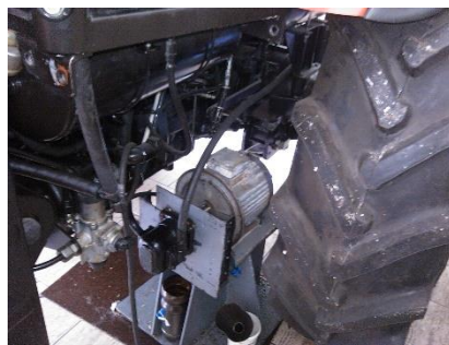
Рисунок 3 – Насосная станция стенда
