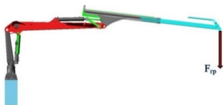
Рисунок 1 – Схема нагружения манипулятора
