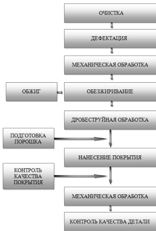
Рисунок 1 – Блок-схема технологического процесса восстановления детали методом газотермического напыления
