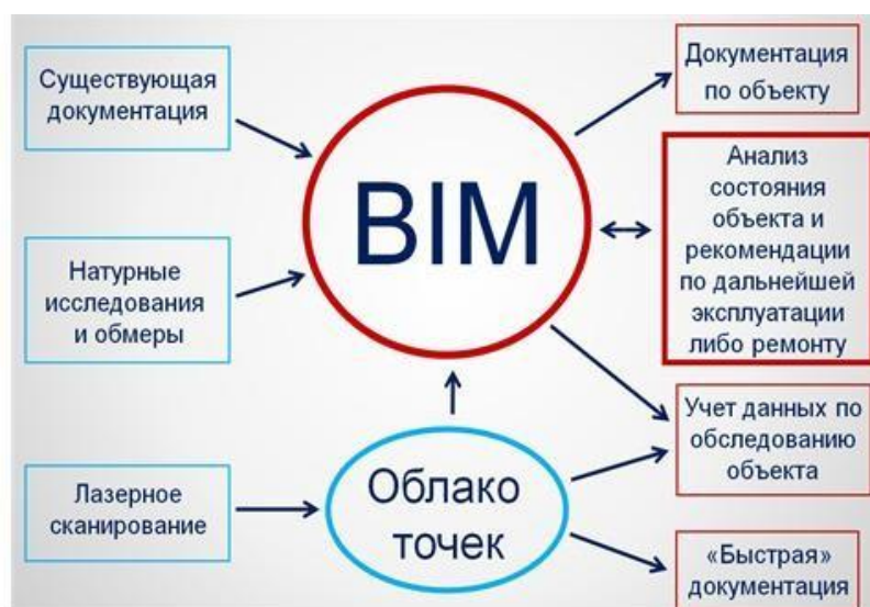
Рисунок 9.5. Контроль точности возведения объекта с помощью лазерного сканирования
