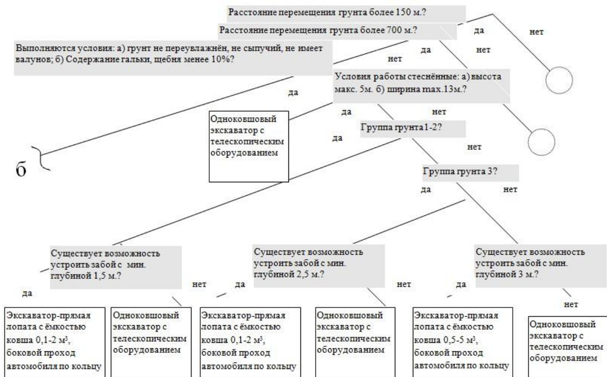
Рисунок 8.10. . Участок базы знаний ЭС по выбору методов производства и средств механизации земляных работ в строительстве.
