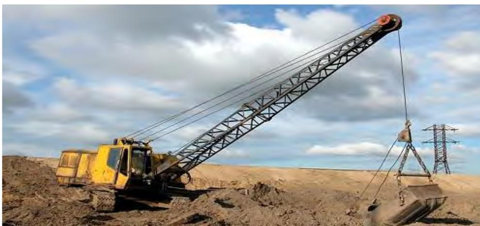
Рисунок 2 – Экскаватор одноковшовый с сменным оборудованием (драглайн)
