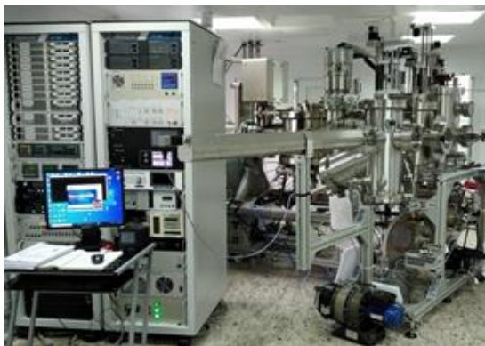
Рисунок 2 – Установка молекулярно-пучковой эпитаксии нитридных гетероструктур Института физики НАН Беларуси
