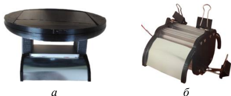
Рисунок 2 – Фотографии светодиодных ловушек автономной (а) и стационарной (б)
