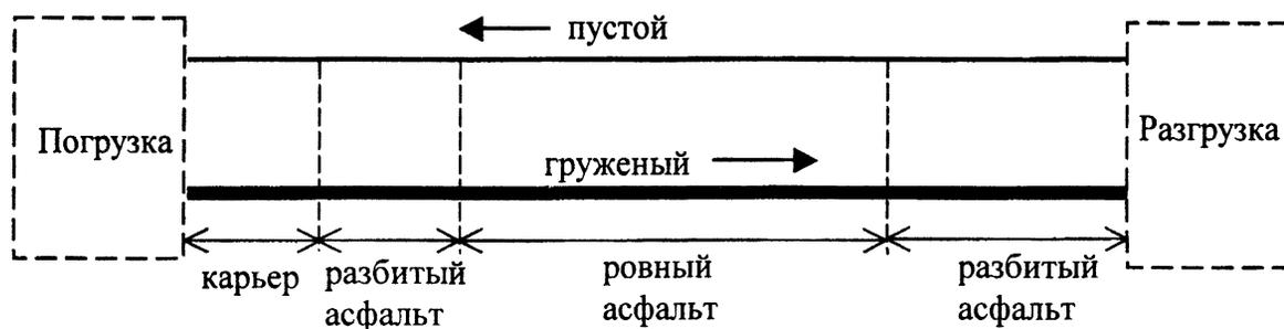
Рис. 1. Схема рабочего цикла автомобиля-самосвала
