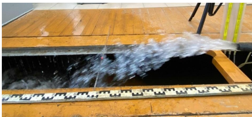
Рисунок 4 – Лабораторные испытания проведенные на модели поворотного участка трубы земснаряда с круглым поперечным сечением
