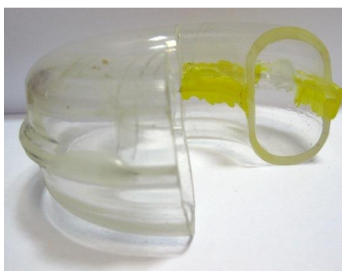
Рисунок 5– Модель поворотного участка трубы земснаряда с овальной формой поперечного сечения
