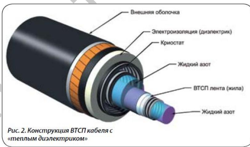
Рис. 2. Конструкция ВТСП кабеля с «теплым диэлектриком»
