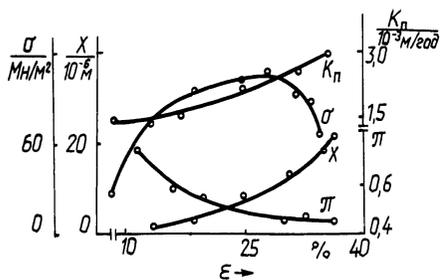
Рис. 2. Влияние пластической деформации в зоне сварного шва на строение и свойства переходной зоны биметалла Ст3-АДО ( $\sigma$  — прочность соединения; X — число включений;  $K_{\Pi}$  — глубинный показатель коррозии;  $\pi$  — коэффициент пассивации в 0,1 N растворе NaCl)
