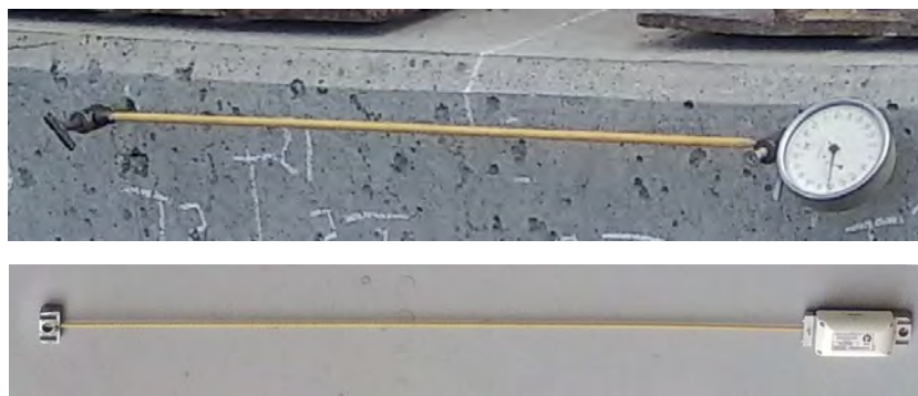
Рис. 7.6. Пример установки аналоговых и электронных индикаторов
