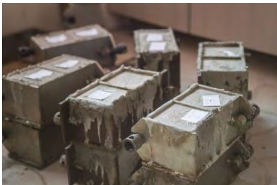
Рис. 2.1. изготовление образцов бетона в металлических формах
