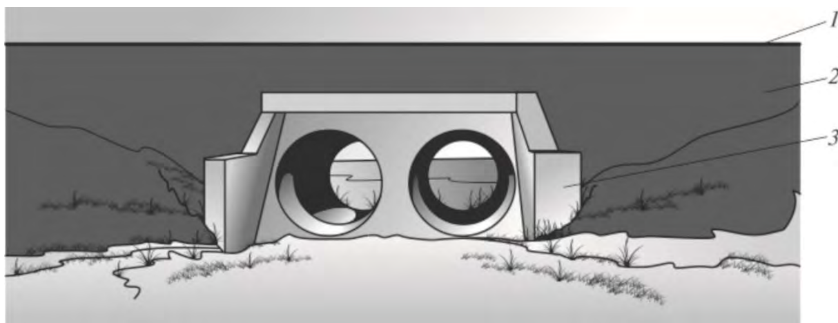
Рис 2.1. Схема расположения водопропускной трубы в теле земляного полотна: 1- уровень проезжей части, 2 – земляное полотно, 3 – элемент оголовка трубы
