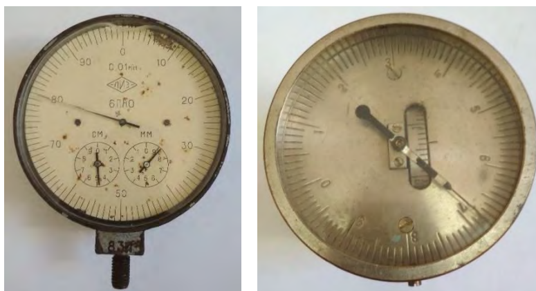
Рис. 7.1. Лицевая сторона прогибомеров. Слева – прогибомер Аистова-Овчинникова Справа – прогибомер Максимова
