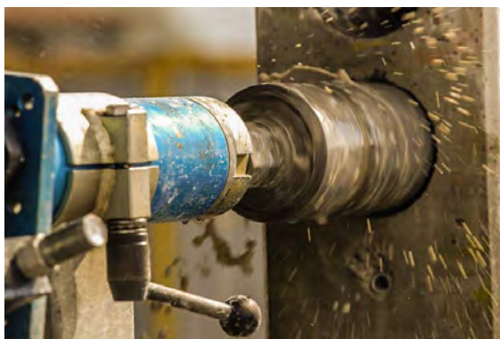
Рис. 2.3. высверливание цилиндрического образца бетона
