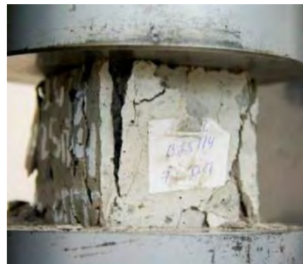
Рис. 2.2. Испытание кубического образца бетона
