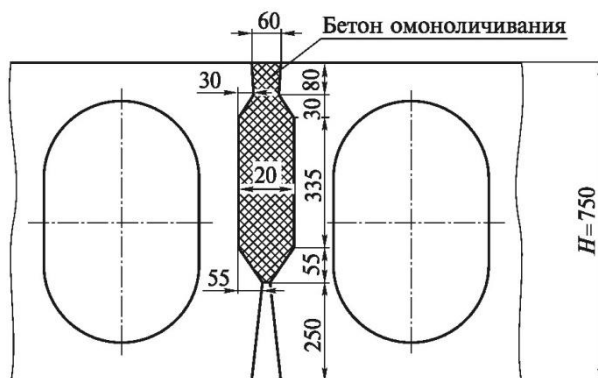
Рис. 16.6. Узел омоноличивания блоков плитного строения
