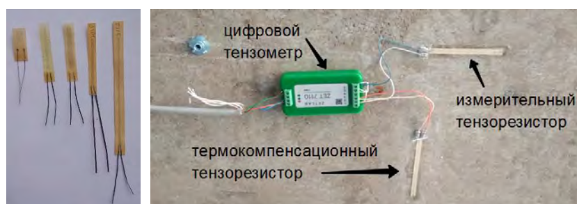
Рис. 7.8. Общий вид тензорезисторов и пример подключения к тензометру по полумостовой схеме
