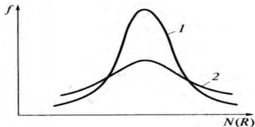
Рис. 15.1. Кривые плотности распределения нагрузок и прочности материалов
