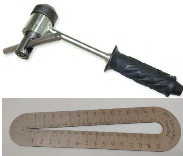
Рис. 2.11. Общий вид Молотка Кашкарова и углового масштаба для определения диаметра отпечатка
