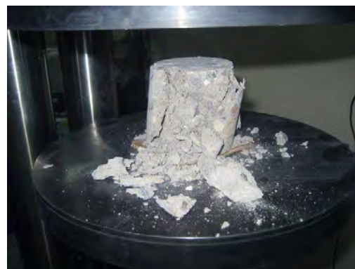
Рис. 2.4. Испытание цилиндрического образца бетона
