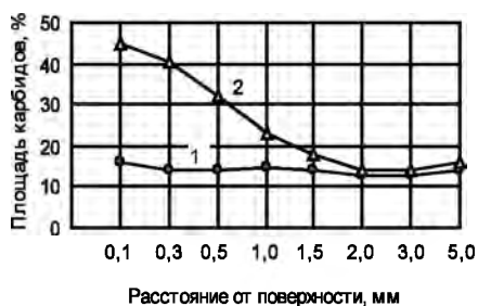
Рис. 3. Распределение карбидов в поверхностных слоях стали X12Ф1: 1 – необработанная; 2 – карбидизированная
