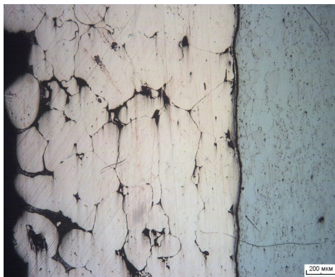
Рисунок 1 – Микроструктура двухслойного материала с неравномерной пористостью
