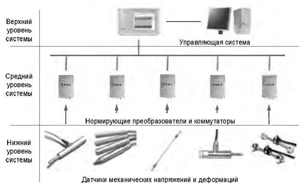
Рис. 2. Типовая структура системы строительного мониторинга
