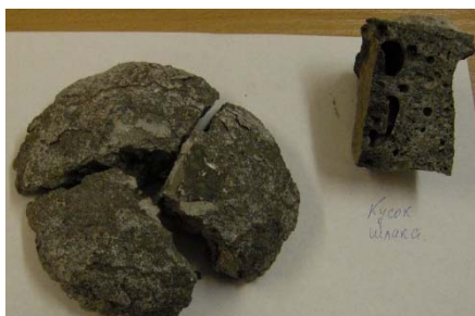
Рисунок 4 – Общий вид продуктов восстановительной плавки
