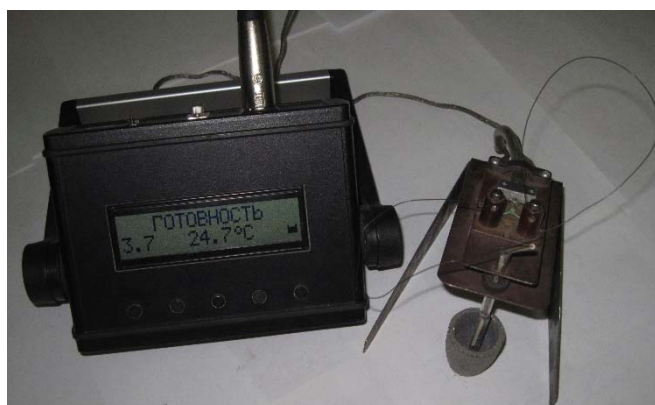
Рисунок 1 – Внешний вид микропроцессорной системы термического анализа металлов и сплавов
