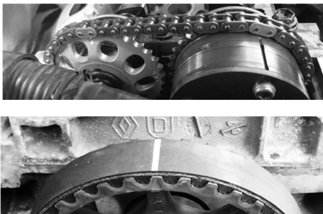
Рис. 10.7. Метки на цепи и ремне ГРМ и соответствующие им метки на звездочках и шкиве
