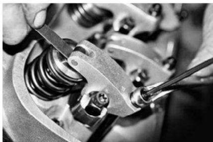
Рис. 10.11. Регулировка зазора в клапанах ГРМ винтом
