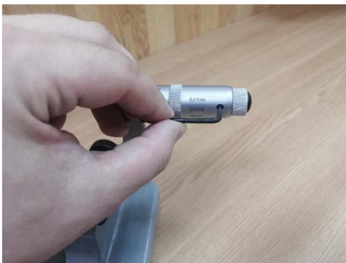
Рис. 1.2.8. Освобождение барабана микрометра гладкого с помощью ключа
