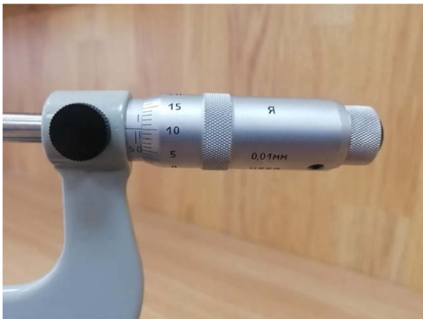
Рис. 1.2.10. Пример снятия показаний при измерении микрометром (вариант 2)
