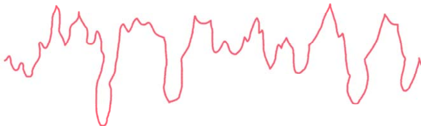
Рис. 4.1.4. Пример профилограммы поверхности
