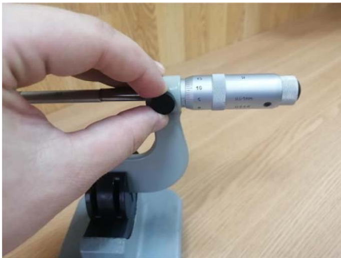
Рис. 1.2.7. Закрепление измерительного стержня гладкого микрометра
