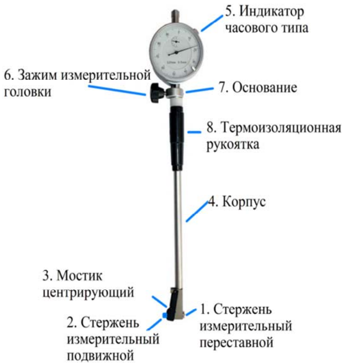
Рис. 1.3.3. Внешний вид нутромера индикаторного (НИ)
