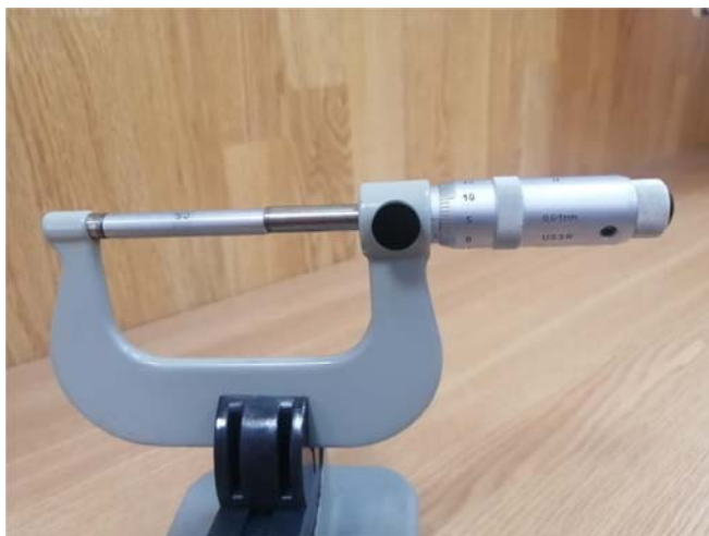
Рис. 1.2.6. Пример расположения шкал микрометра при неправильной установке на ноль
