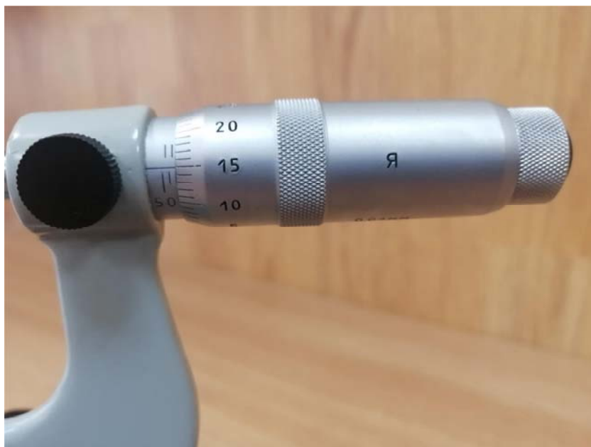
Рис. 1.2.9. Пример снятия показаний при измерении микрометром (вариант 1)
