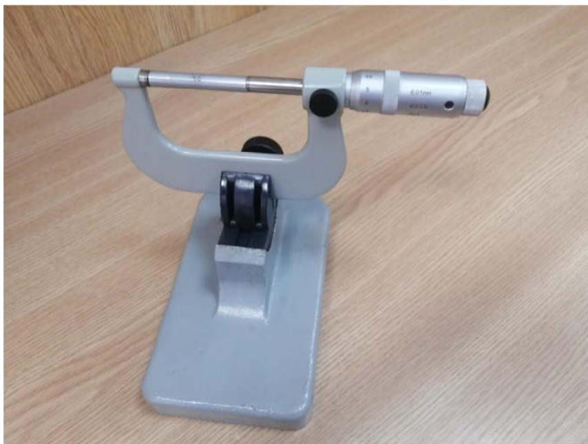
Рис. 1.2.4. Пример установки микрометра гладкого в стойке
