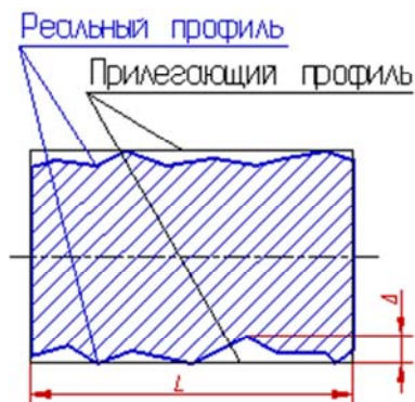
Рис. 2.2.9. Отклонение профиля продольного сечения
