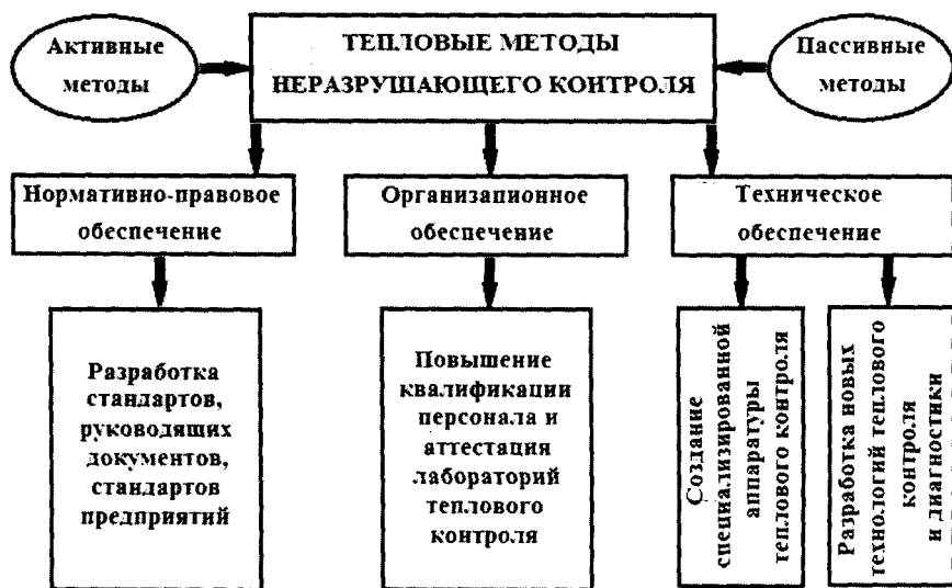
Рис. 6. Приоритетные направления разработки обеспечений тепловых методов неразрушающего контроля
