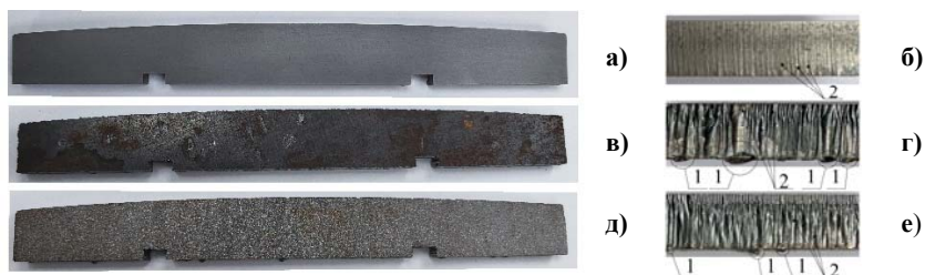
1 – грат на кромке реза; 2 – линии бороздок реза; а, б – образец № 1, прошедший перед ЛР РСО ( L = 30 мм, v_{стр} = 190 м/с, p_{вх} = 20 МПа, Ra = 2-4 мкм, d_c = 1,2 мм, H_{\mu} = 2580-2650 МПа); в, г – образец № 2, прошедший ЛР без предварительной обработки (в состоянии поставки) ( Ra = 20-30 мкм, H_{\mu} = 1900-2000 МПа); д, е – образец № 3, прошедший перед ЛР предварительную обработку поверхности по заводской дробеструйной технологии ( Ra = 0,25-0,5 мкм, H_{\mu} = 3100-3200 МПа; материал – сталь СтЗпс; толщина листа S_{л} = 10 мм; V_{др} = 1,7 м/мин
