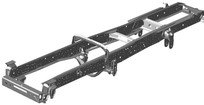
Рис. 1. Трехмерная модель рамы седельного тягача
