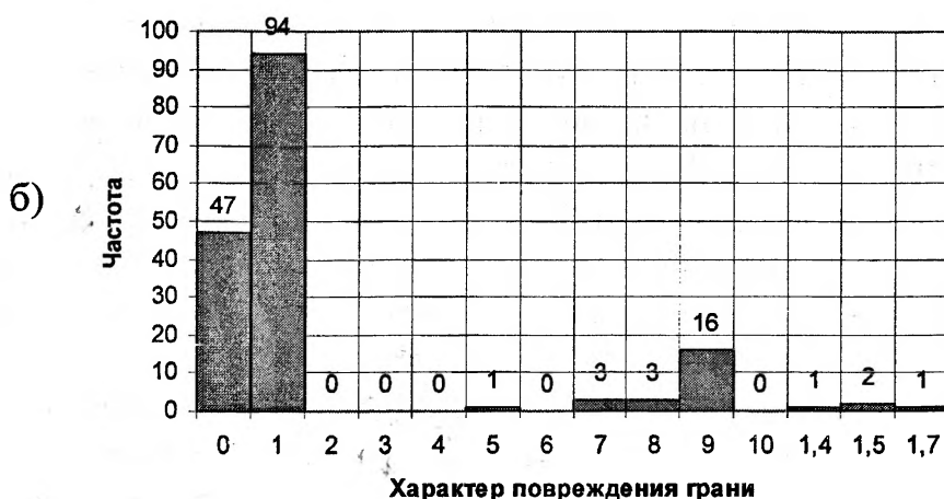
Рисунок 2-Гистограмма характера повреждения режущих граней торцовых фрез \varnothing 315 мм в момент съема со станка: а) с числом зубьев z=40 (суммарное количество граней – 440) б) с числом зубьев z=24 (суммарное количество граней – 168)
