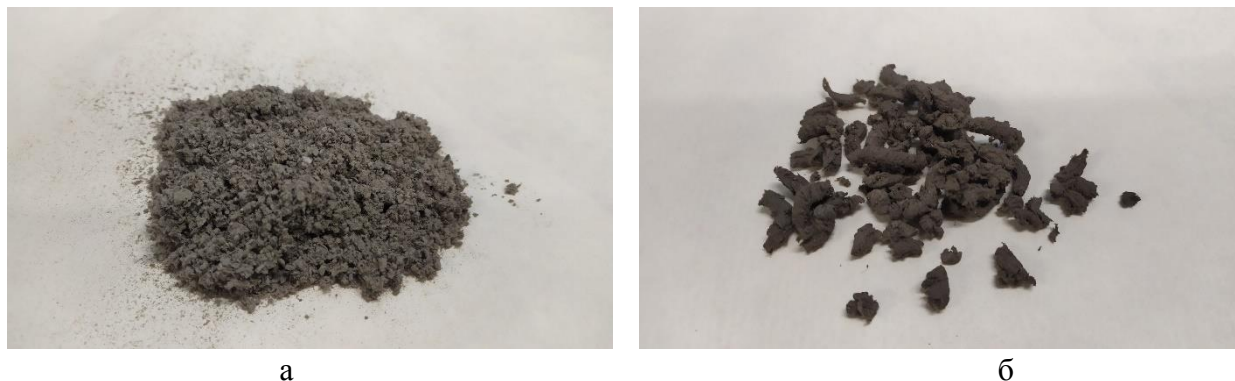
Рисунок 1 – Общий вид отхода (скопа) целлюлозно-бумажной промышленности: а – распущенный скоп; б – гранулированный скоп
