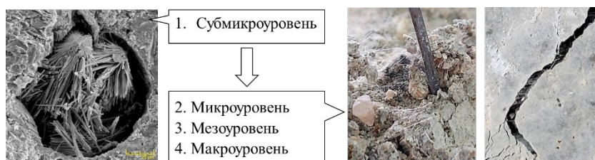
Рисунок 3. Уровни строения структуры напрягающего фибробетона
