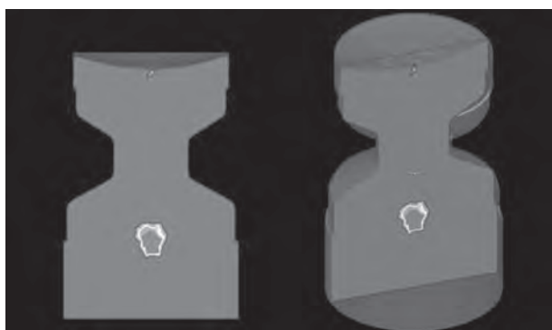
Рис. 9. Сечение анализируемой отливки из алюминиевого сплава состава Al-9%Si-2%Cu-0,5%Mg-0,4%Mn
