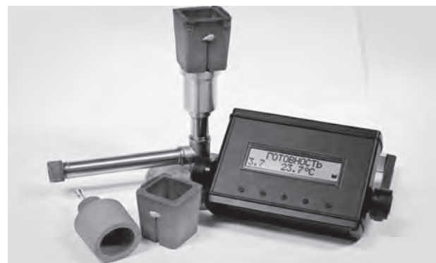
Рис. 2. Общий вид микропроцессорной системы для термоанализа литейных сплавов
