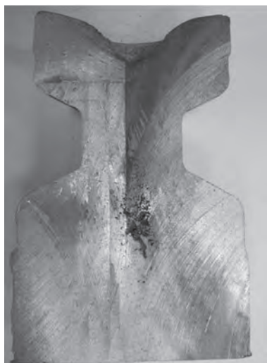
Рис. 9. Сечение анализируемой отливки из алюминиевого сплава состава Al-9%Si-2%Cu-0,5%Mg-0,4%Mn
