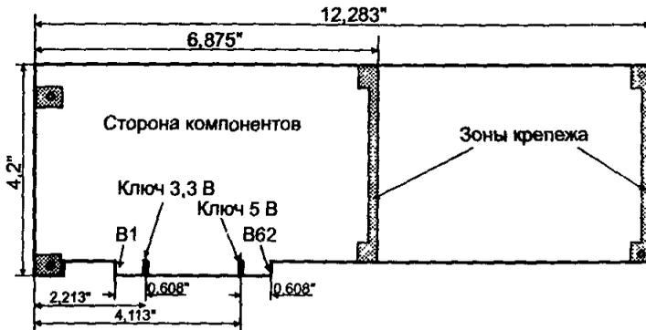
Рис. 5.11. Плата для УС через шину PCI
