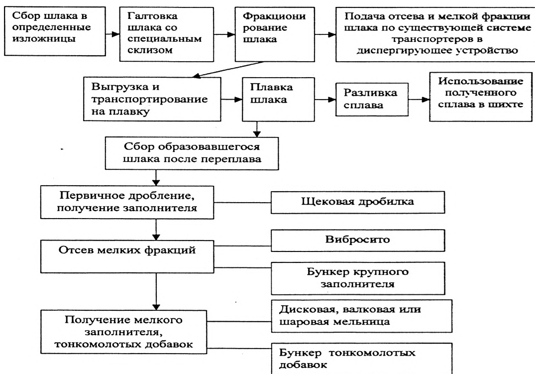
Рис. 4. Участок по переработке шлака
