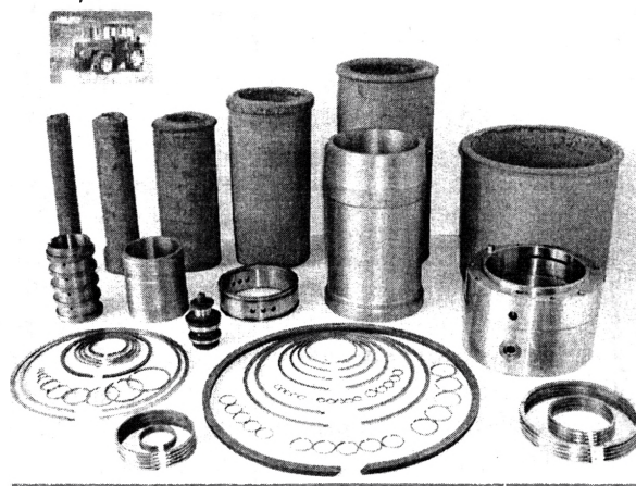
Рис. 2. Изделия, получаемые из отливок, изготовленных методом литья на морозиванием
