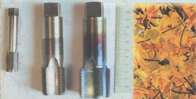
Примеры деталей с алмазоподобными покрытиями
