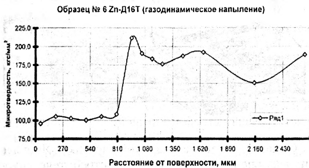
Рис. 2. Распределение микротвердости в системе покрытие/подложка Д16Т: а) Zn+Cu; б) Al+Zn; в) Zn; г) Ni
