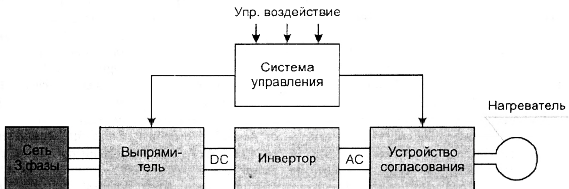
Рис. 1 — Блок-схема полупроводникового источника питания для индукционного нагрева
