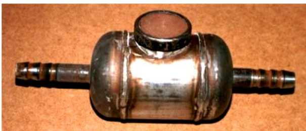
Рис. 9.15. Общий вид емкости для гидрофильной смеси (фотография), используемой при производстве работ
