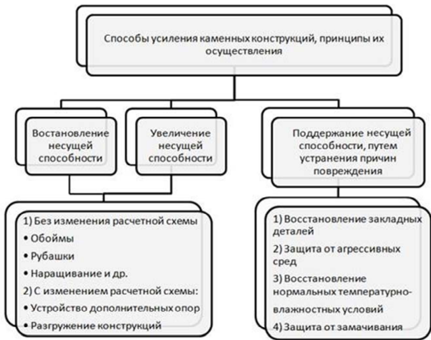
Рис. 5.7. Способы усиления каменных конструкций
