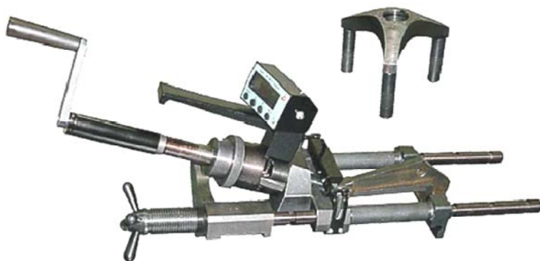
Рис. 1.6. Прибор ПОС-30МГ4 «Скол» для испытания методом скола ребра
