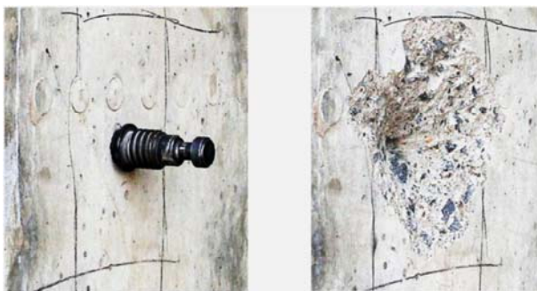
Рис. 1.5. Установленный анкер и лунка после отрыва анкера
