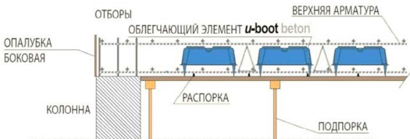
Рис. 6.37. Технологическая схема системы типа U-Boot Beton
