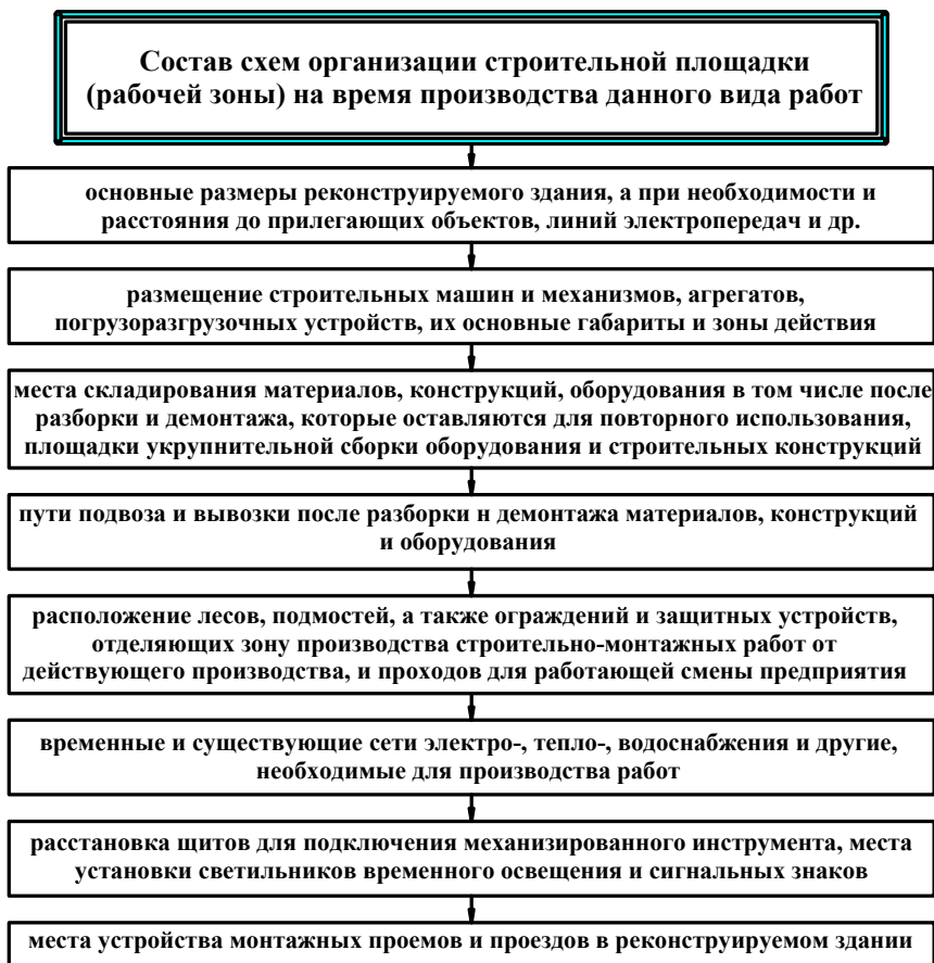
Рис. 2.3. Состав схем организации строительной площадки
