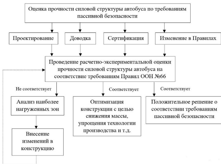
Рисунок 1 – Блок-схема системного взаимодействия расчетных методов исследований и этапов производства
