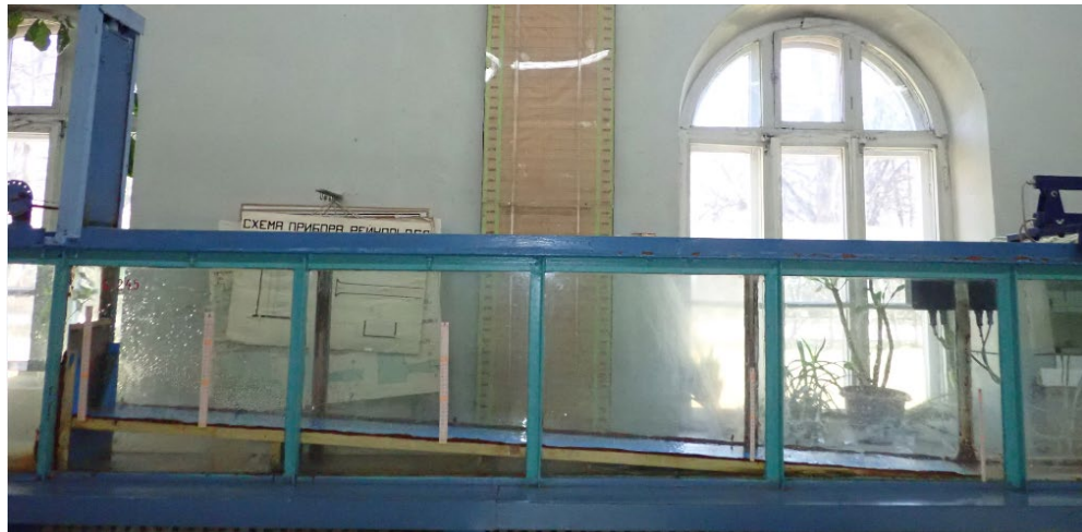
Рисунок 3 – Общий вид экспериментального лабораторного стенда с моделью нижнего бьефа (сухого русла)
