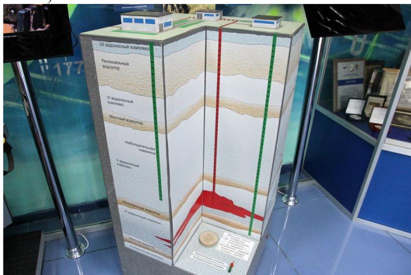
**Рисунок 4. Макет пункта захоронения ЖРО**
