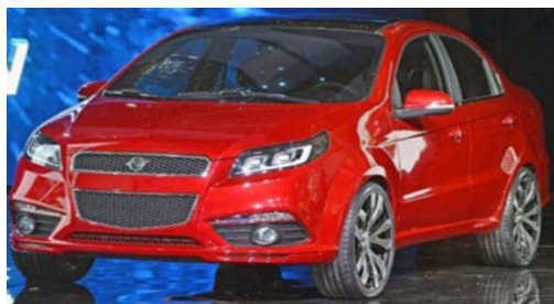
Рисунок 1 – Габариты «ЕЕ Равона»: длина – 4330 мм; ширина – 1690 мм; высота – 1505 мм; размер колесной базы – 2480 мм. Объем багажника – 300 л. Снаряженная масса автомобиля: 1100 – 1200 кг. Полная масса: 1300 – 1350 кг [2]
