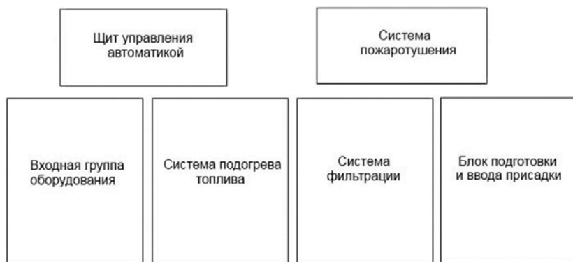
Рисунок 2 – Блок-схема оборудования для ввода и смешивания
