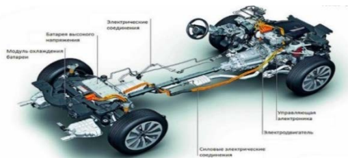
Рисунок 2 – Принципиальная схема гибридного автомобиля [3]
