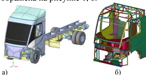
Рисунок 1 –Трехмерная геометрическая модель кабины грузовика а) – исходная (конструкторская) модель; б) – расчетная модель
