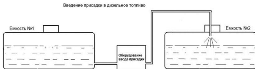
Рисунок 1 – Схема установки для смешивания депрессорной присадки в полевых условиях
