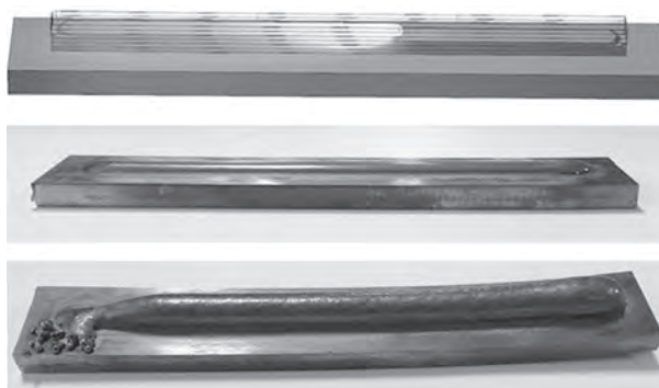
Рисунок 3 — Моделирование детали, созданной методом лазерной наплавки металла [8]
