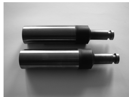
Рис. 2. Процесс нанесения покрытия: а — напыленные и оплавленные; б — шлифованные; в — плунжеры
