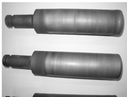
Рис. 2. Процесс нанесения покрытия: а — напыленные и оплавленные; б — шлифованные; в — плунжеры
