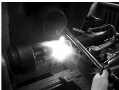
Рис. 2. Процесс нанесения покрытия: а — напыленные и оплавленные; б — шлифованные; в — плунжеры
