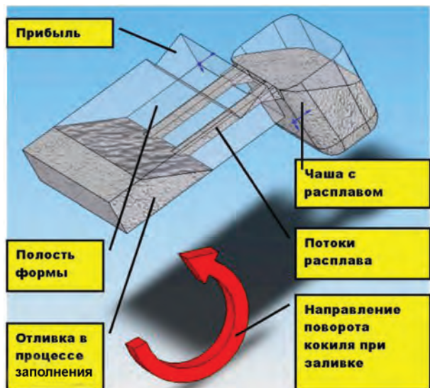
Рис. 1. Схема метода самозаполнения при верхней заливке расплава в кокиль
