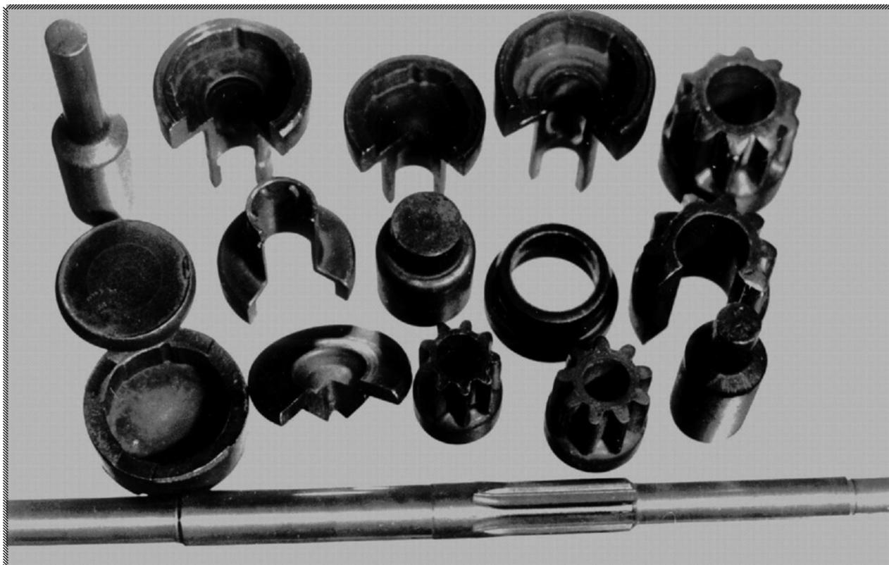
*Детали автотракторного машиностроения, изготавливаемые на заводе «БАТЭ» холодной объемной штамповкой. В 1988 году присуждена Государственная премия БССР*
