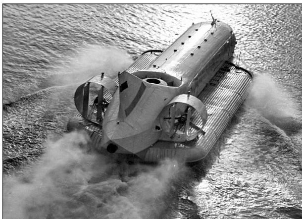
Рис. 3. Пассажирское судно «Сормович». На фото запечатлён момент, когда вентилятор выключен, аппарат переходит из парящего режима в водоизмещающий
