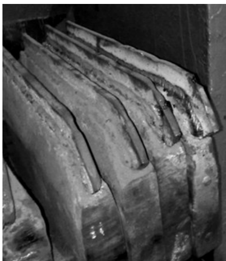
Рис. 4. Внешний вид наплавленных проводок шаропрокатного стана
